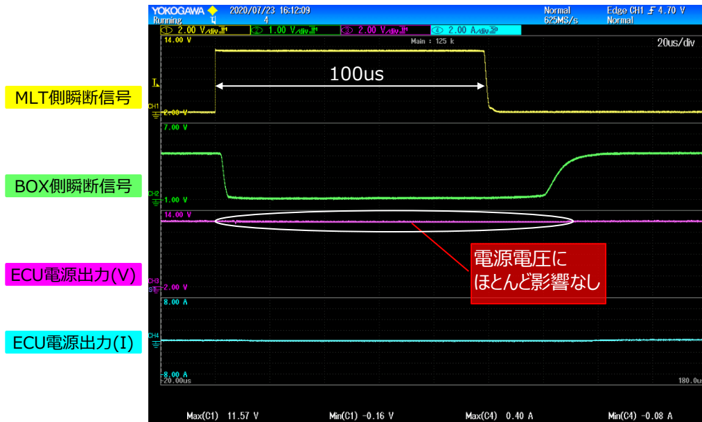
100us電源開放波形
