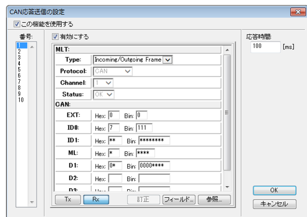
特定のフレームに対して登録フレームを自動応答する応答送信機能
