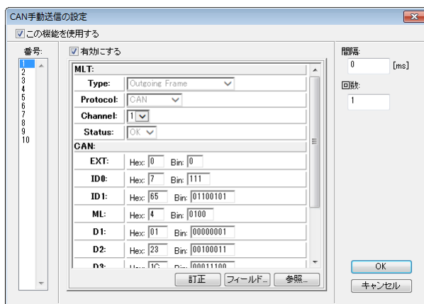
登録フレームをキー操作またはマウス操作で送信する手動送信機能
