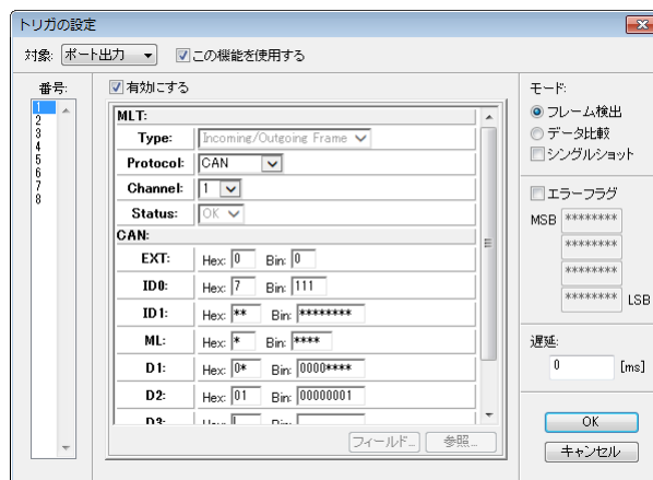
条件にマッチした時にポート入力やポート出力に対してトリガ指示を行うトリガ機能
